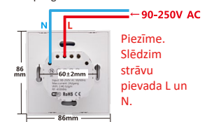
4.1. Apgaismojuma vadu savienošanas instrukcija (piem., 2CH).
