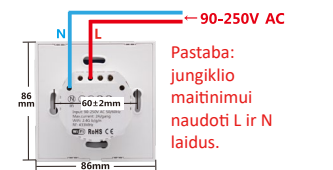
4.1. Šviesų pajungimo schema (pvz., 2 kanalai).
